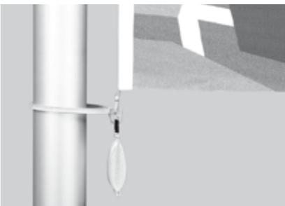
Fahnen­straf­fer­band um den Mast legen und Karabinerhaken an beiden Enden des Bandes einhaken (zweite Öffnung an den Enden des Bandes muss nach unten zeigen).
